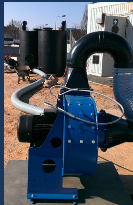
▲ Radialventilator zur Luftabsaugung
